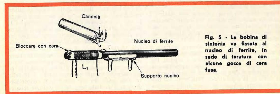
Fig. 5 - La bobina di sintonia va fissata al nucleo di ferrite, in sede di taratura con alcune gocce di cera fusa.
